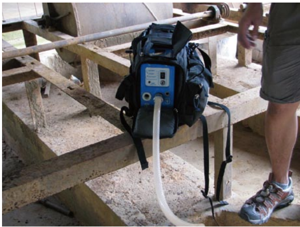
写真 1 フィリピン北カマリネス州Paracaleの採鉱現地にて使用中の水銀濃度分析計“Lumex”
