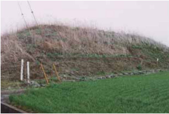
江南町成沢（体積概算7,000m 3 ） 鉛含有濃度760mg/kgのアルミ精錬灰が投棄されていた。
