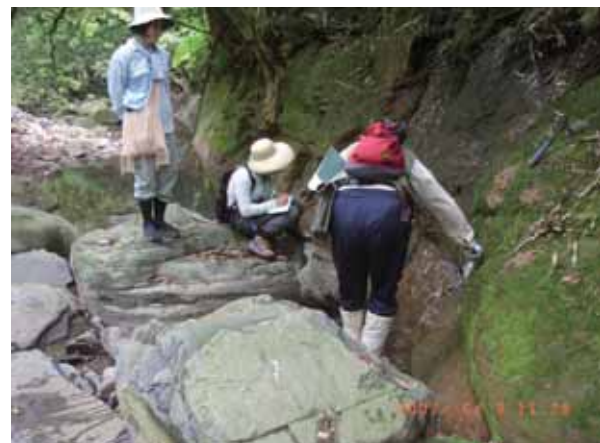
図5 白岩火砕流堆積物の地層面を観察する。足下の安山岩溶岩の転石に比べ、火砕流堆積物はハンマーで叩くと柔らかい。
