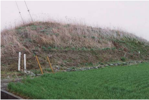
江南町成沢（体積概算7,000m 3 ） 鉛含有濃度760mg/kgのアルミ精錬灰が投棄されていた。
