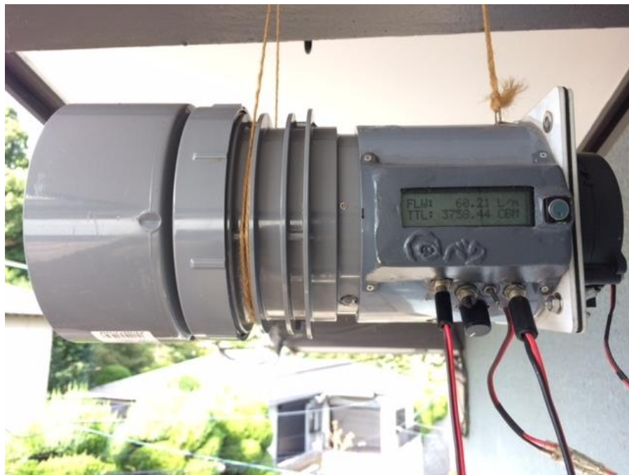
ソーラーパネルからの電力で長期テスト中の2号機
