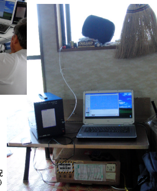
VOC測定器の設置状況 (五ノ坪集会所)
