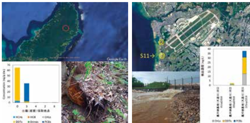
国頭村安田の米軍北部訓練場返還跡地の土壌分析結果。ゴミの調査をしている市民から、米軍廃棄物発見地点の土壌の提供を受けた。廃棄物が見られた地点周辺(0)でDDT類、廃棄ドラム缶があった地点(3)でPCBが検出された
